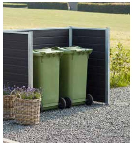
Selbstmontage. WPC-Planken: 18×145mm schiefergraue Struktur. Rahmen in feuerverzinktem Stahl. Ober-/Bodenprofil: 27×30×1,5mm. Seitenprofil: 23×30×2mm – direkt an den Pfosten montiert. Pfosten: 4,5×4,5×186 cm feuerverzinkter Stahl. Inkl. Schrauben.
